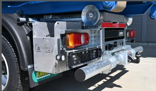
Heckunterfahrschutz mit Kugelkopfkupplung
