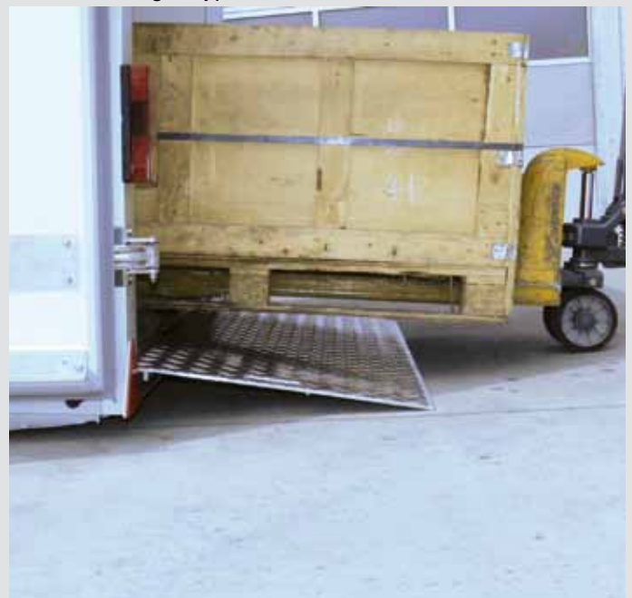
flacher Auffahrwinkel für müheloses Beladen
