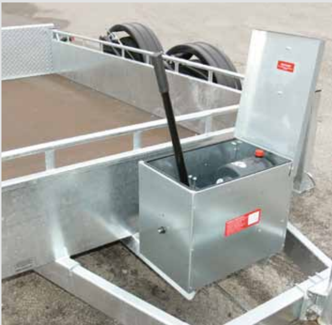
Hydraulik mit Handpumpe
