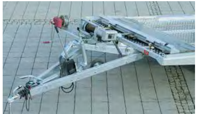
Hydraulische Kippeinrichtung mit Stützradautomatik. (Hier in Heavy-Duty-Ausführung an einem Hänger mit Crash-Lift).
