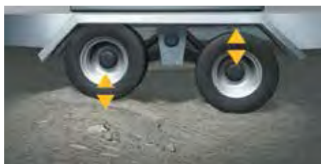
Einzelradaufhängung und Dreieckslenker mit Pendelachsen sorgen für sichere Bodenhaftung und kontinuierliche Stützlast am Zugfahrzeug.
