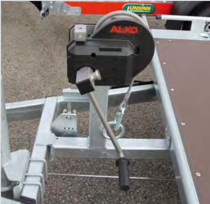
Seilwinde auf Windenbock montiert
