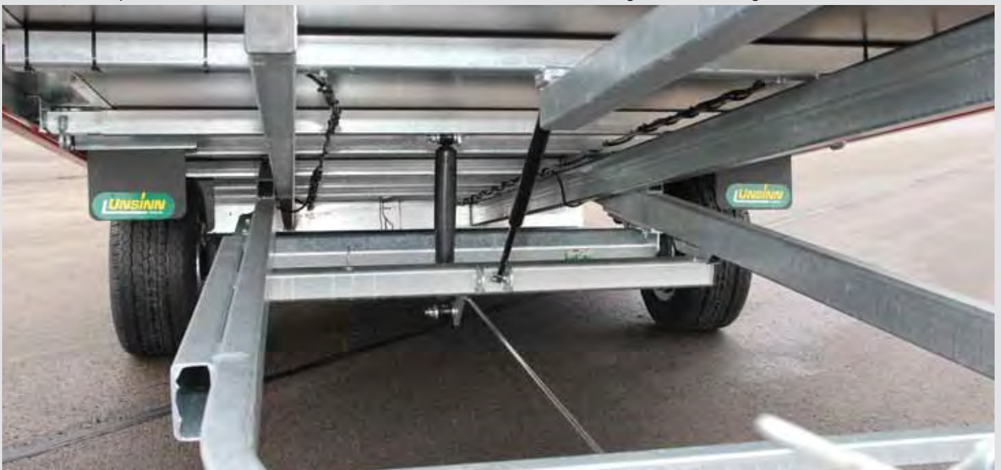
Gasfeder als Hubhilfe
