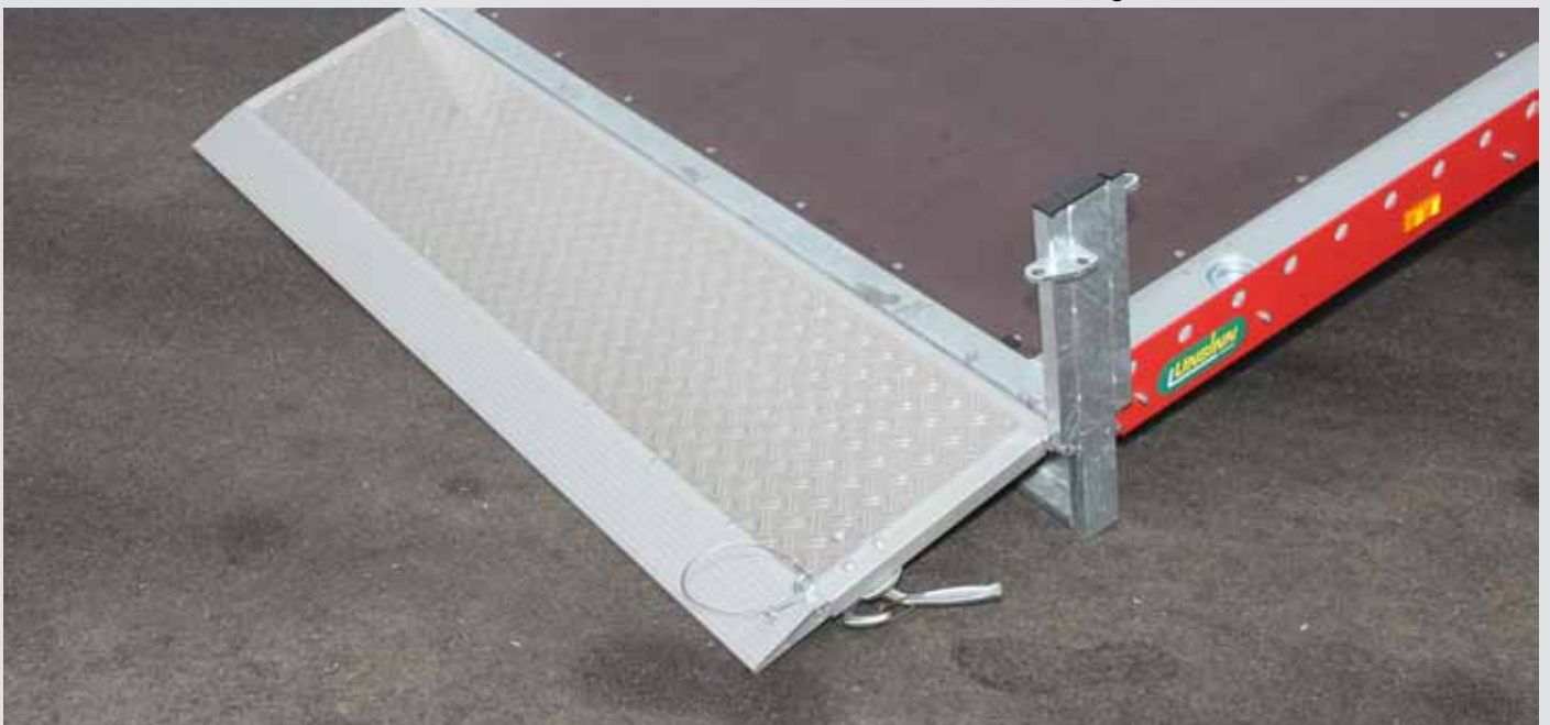
durchgehende Auffahrklappe mit rutschhemmendem Riffelblech
