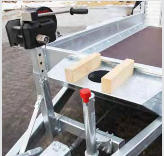
Baggerarmauflage, Windenbock mit Handseilwinde
