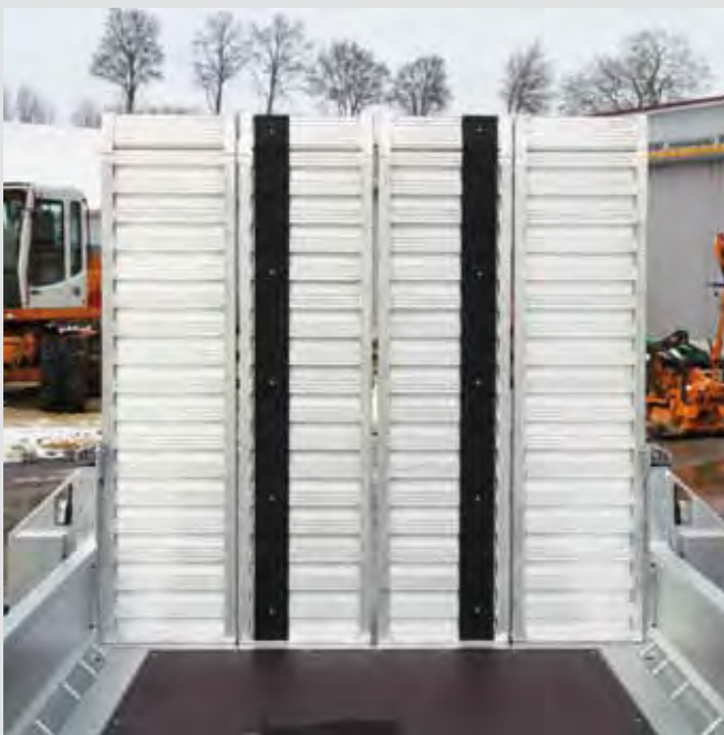
durchgehende Auffahrampen mit Gummiauflage
