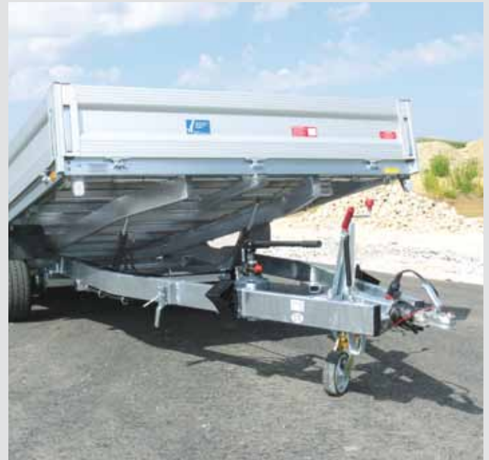
verschweißter und feuerverzinkter Stahlrahmen
