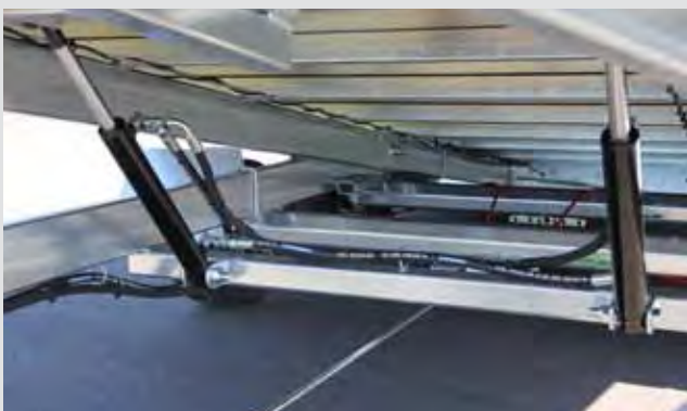
Hydraulik doppelwirkend und mit zwei Zylindern
