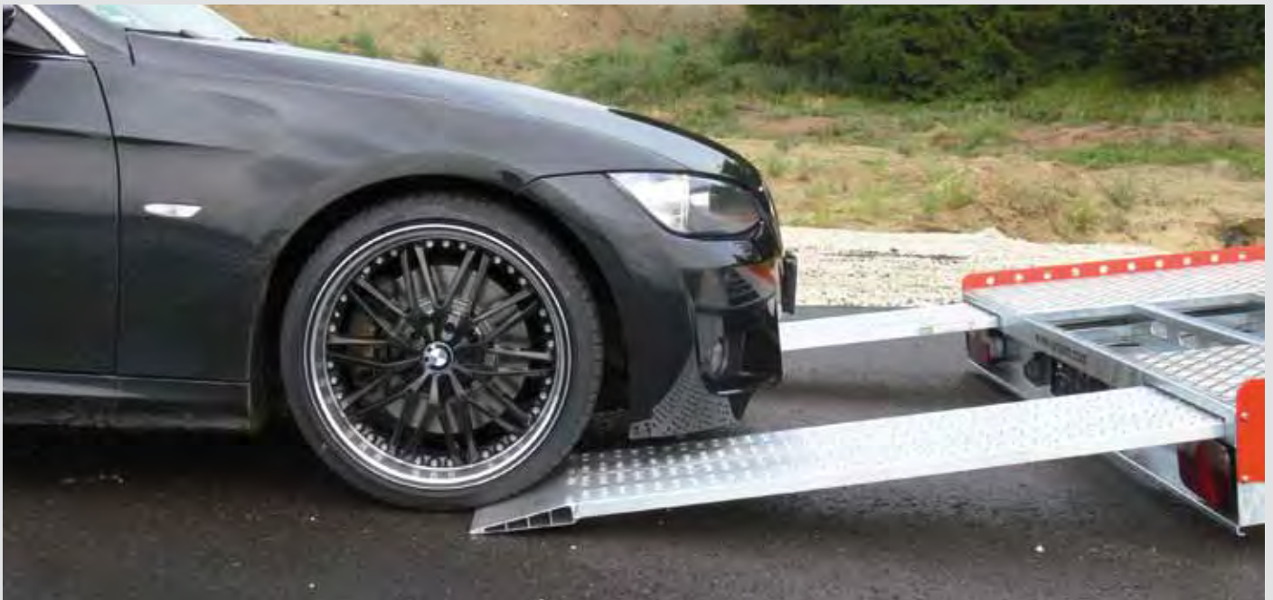
geringer Auffahrwinkel für Fahrzeuge mit wenig Bodenfreiheit
