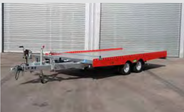
verschweißter und feuerverzinkter Stahlrahmen
