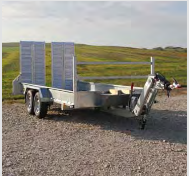
höhenverstellbare Zugdeichsel, zusätzliche Auffahrrampen
