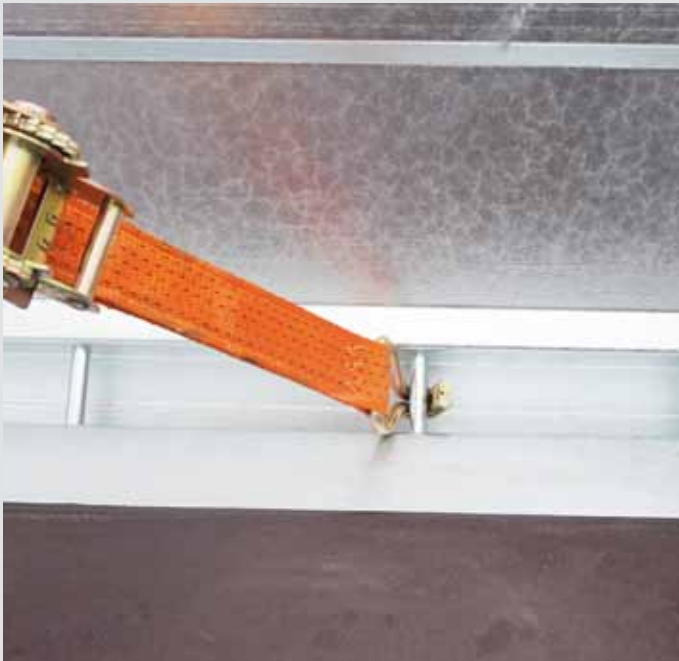
Zurrpunkt mit 2000 kg Zugkraft
