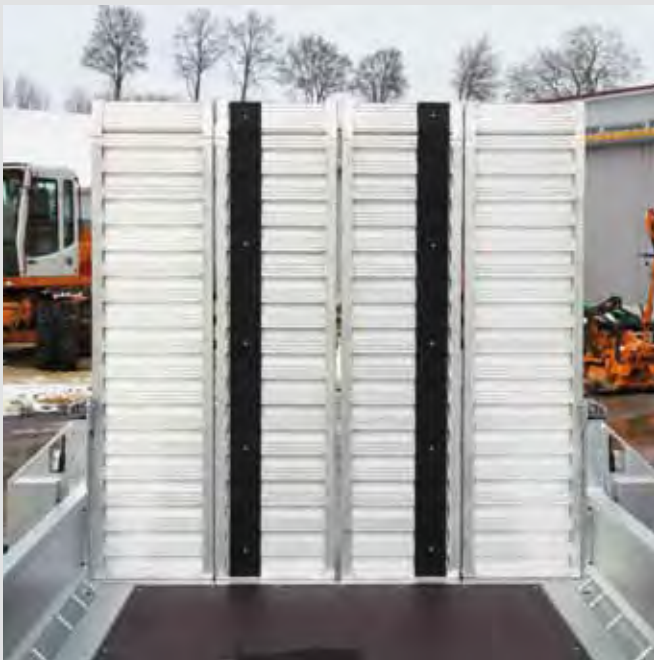
durchgehende Auffahrrampen mit Gummiauflage
