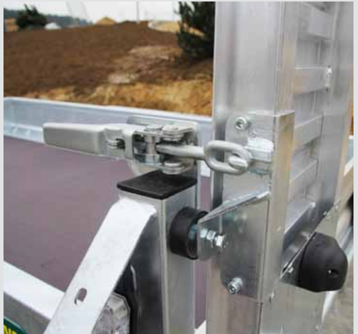
Spannverschluss der Auffahrrampen
